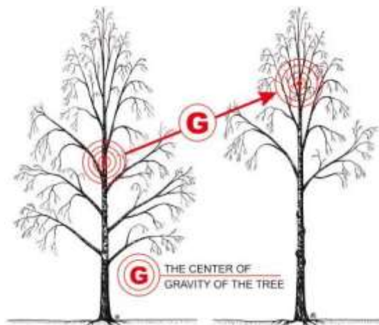
Рисунок 15: Увеличение механической нагрузки на дерево из-за поднятия центра тяжести может увеличить риск поломки дерева.
